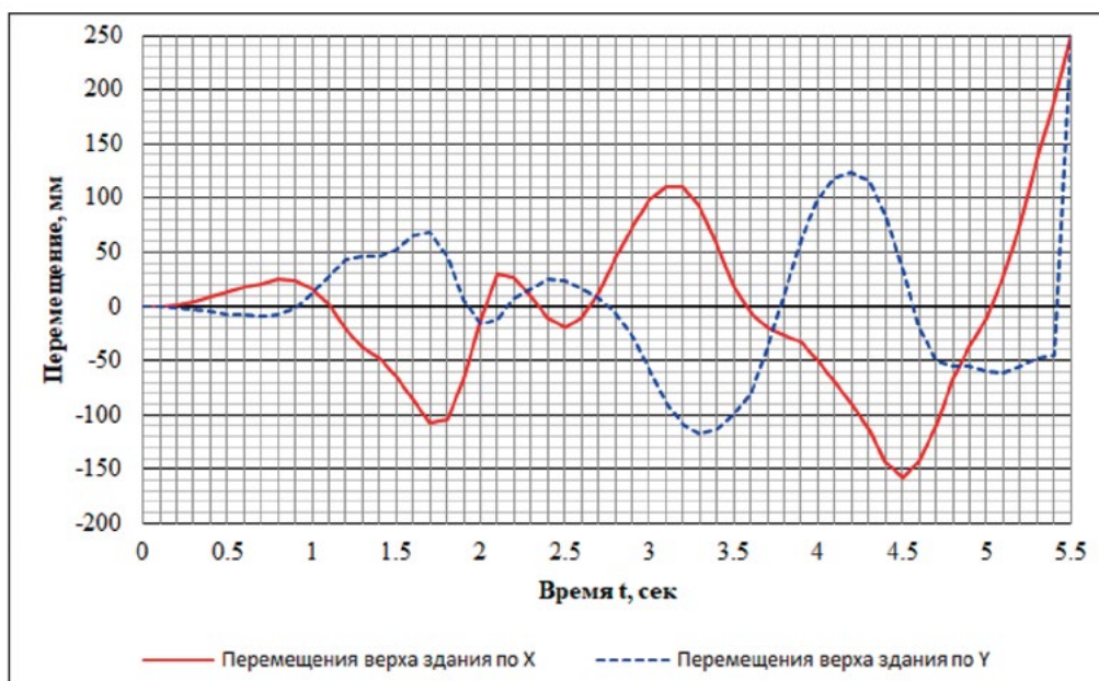
Рисунок 8 — Перемещения верха тестовой модели по направлениям X и Y во времени Figure 8 — Displacement the top of the test model in the X and Y directions in time
